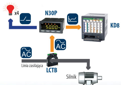
Pomiar, sygnalizacja przekroczeń i rejestracja prądu obciążenia silnika jednofazowego
